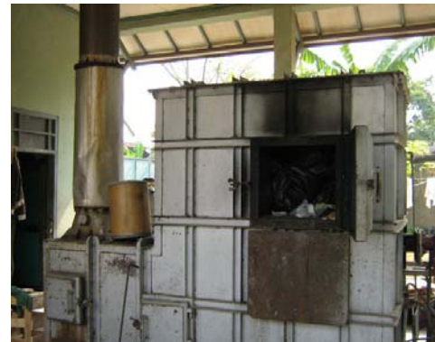
Insinerator di RS Al Ihsan dengan kapasitas 1 \text{ m}^3 , dioperasikan 2 kali seminggu
