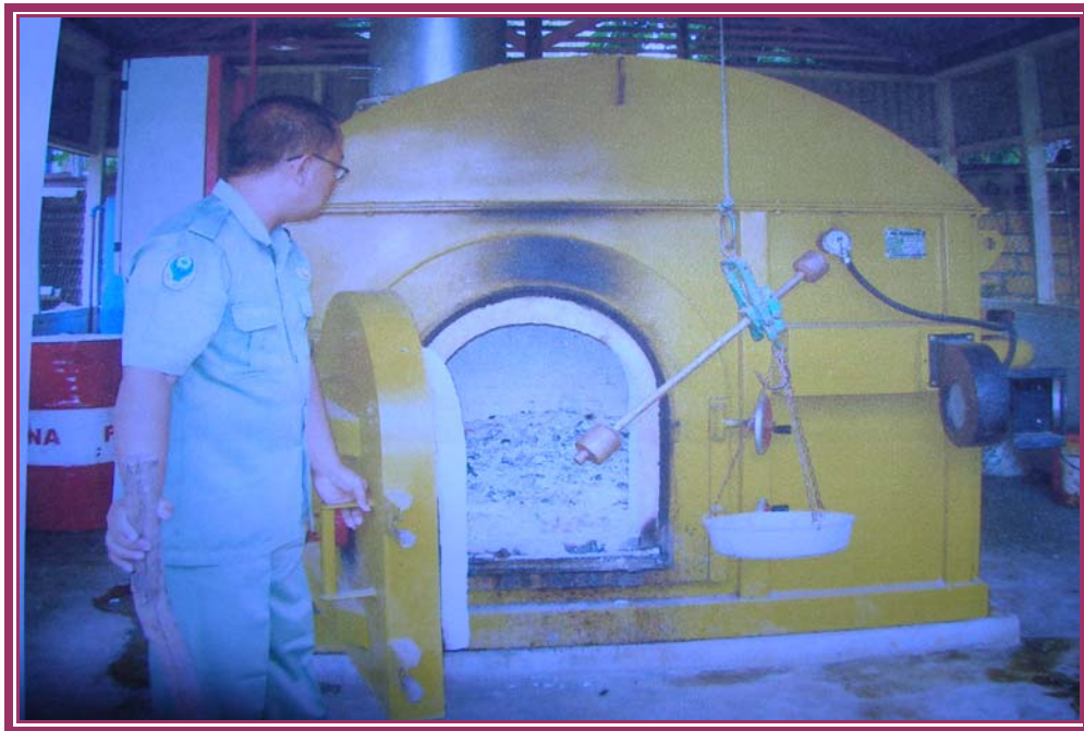
Gambar 3.7. Pengelolaan Sampah Medis dengan Incenerator
