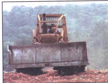
Pendorongan dan Pemasatan Sampah oleh Alat Berat Bulldozer
