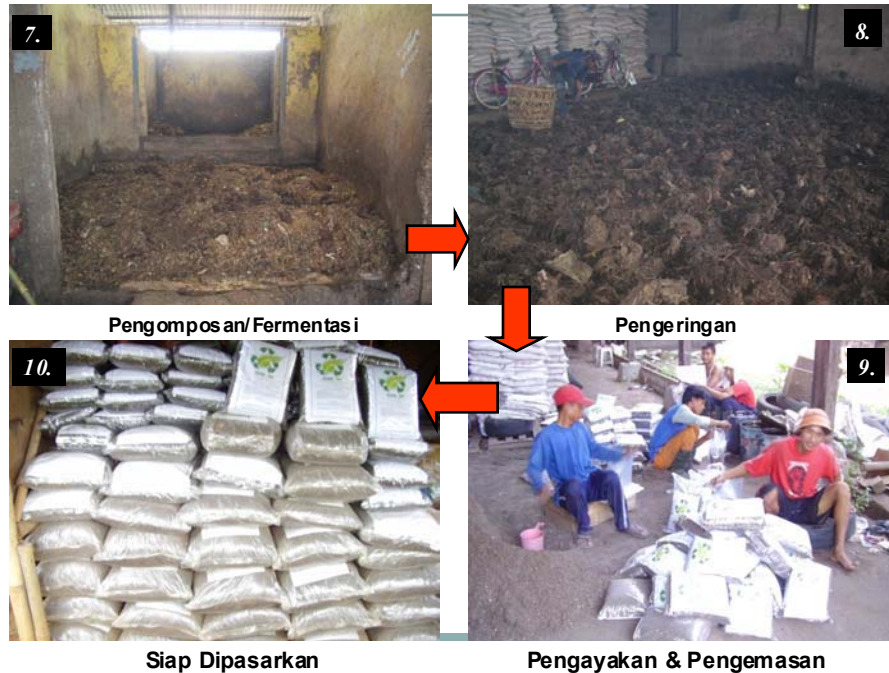
Gambar 7.13. Proses Produksi Kompos Pupuk Organik pada TPARAwa Kucing
