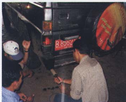
Pemasangan Probe Pada Kendaraan
