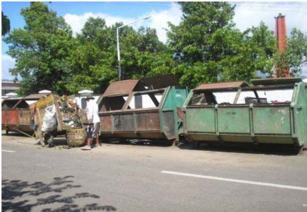
Gambar 5.6. Container bak sampah untuk pengangkutan ke TPA, ada beberapa kondisi container yang perlu di perbaiki.
