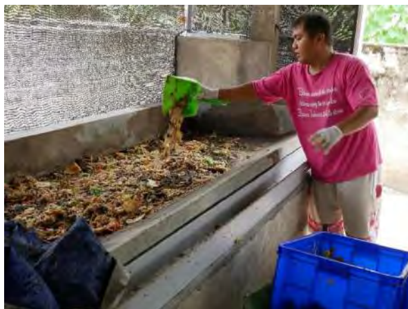
Proses Gambar 4.14. Pemasukan sampah ke Bioreaktor
