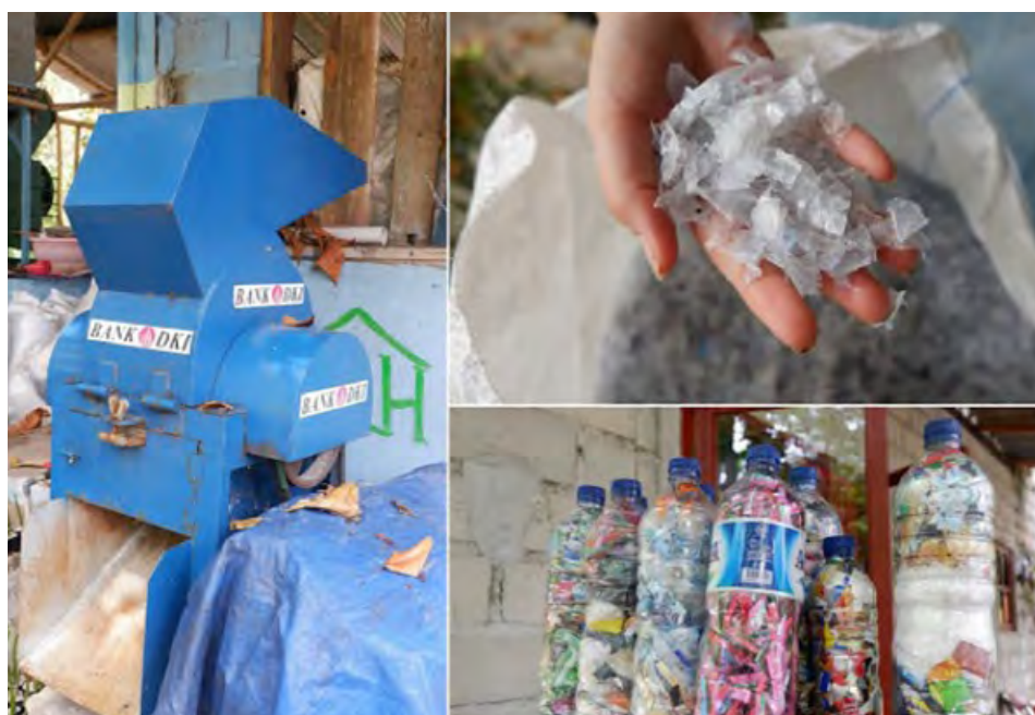
Gambar IV.3 Mesin Pencacah Sampah (kiri), sampah plastik yang dicacah (kanan atas) dan eco-brick dalam Program Pulauku NOL Sampah
