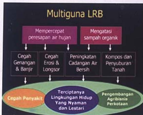
Gambar 1. Keunggulan Lubang Resapan Biopori
